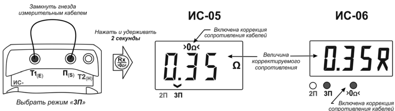
Рисунок 3 – Коррекция сопротивления измерительного кабеля (3П)
