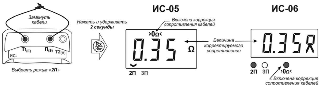
Рисунок 4 – Коррекция сопротивления измерительных кабелей (2П)
