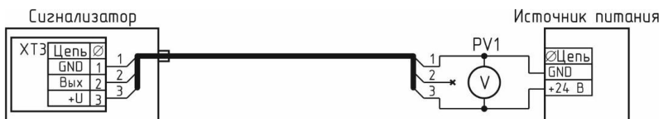
Рисунок Е.1 – Схема включения сигнализатора.
