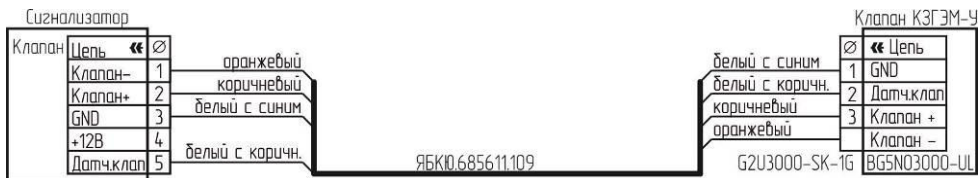
Рисунок Г.6 – Схема подключения клапана КЗГЭМ-У с разъемом ВГ5НО3000-UL.
