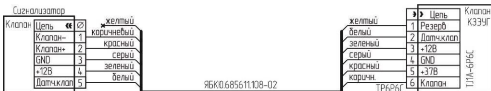
Рисунок Г.8 – Схема подключения клапана КЗЭУГ с разъемом Т1А-6Р6С
