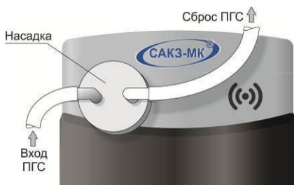
Рисунок Е.2 – Установка насадки для подачи ПГС
