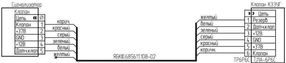
Рисунок В.6 – Схема подключения клапана КЗЭУГ с разъемом TJ1A-6P6C
