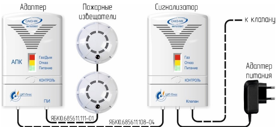
Рисунок Б.2 – Типовая схема подключения пожарных извещателей
