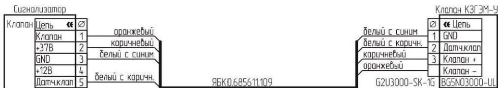
Рисунок В.4 – Схема подключения клапана КЗГЭМ-У с разъемом BG5NO3000-UL.
