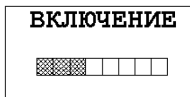
Рисунок 2.1 – Вид табло при включении газоанализатора
