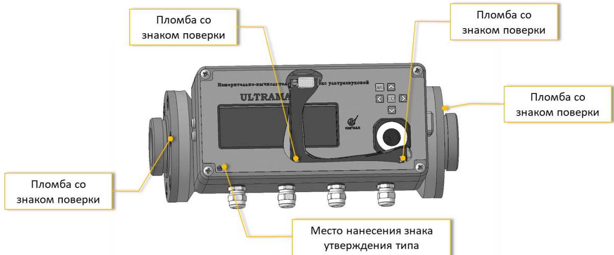
Рисунок 5 – Схема пломбирования и место нанесения знака утверждения типа расходомера с базовым ИВБ, резьбовым соединением и аксиальным расположением ПЭП
