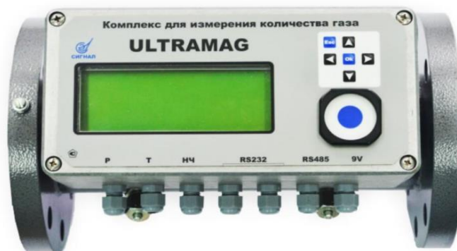
Рисунок 2 – Внешний вид расходомера с базовым ИВБ, фланцевым соединением и аксиальным расположением ПЭП
