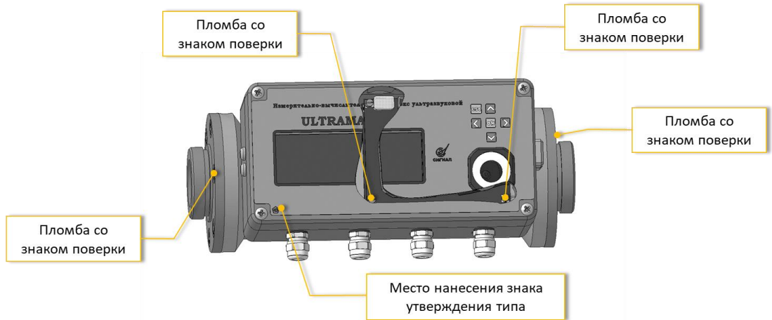
Рисунок 5 – Схема пломбирования и место нанесения знака утверждения типа расходомера с базовым ИВБ, резьбовым соединением и аксиальным расположением ПЭП
