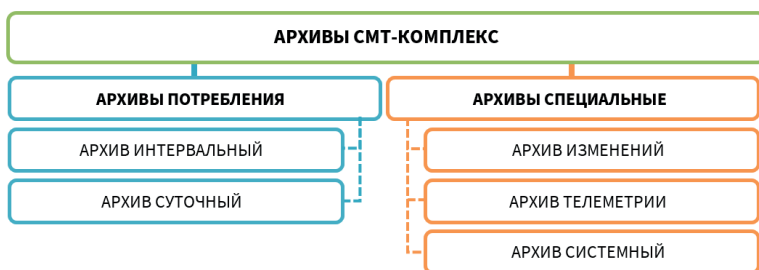
Рисунок 9. Структура архивных данных СМТ-Комплекс
