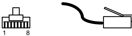
а) вид и нумерация контактов разъема RJ45
