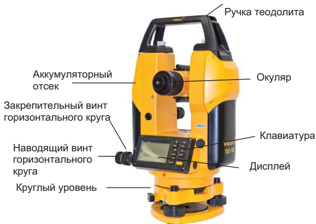
Рис. 2 Части прибора (круг Право)
