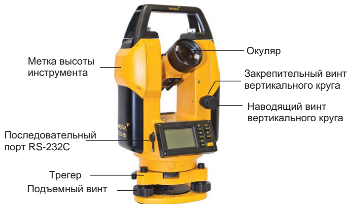
Рис. 3 Части прибора (круг Лето)
