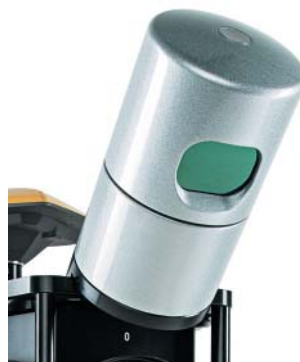
Сканер, откалиброванный Торсон, имеет 32 лазерных излучателя
