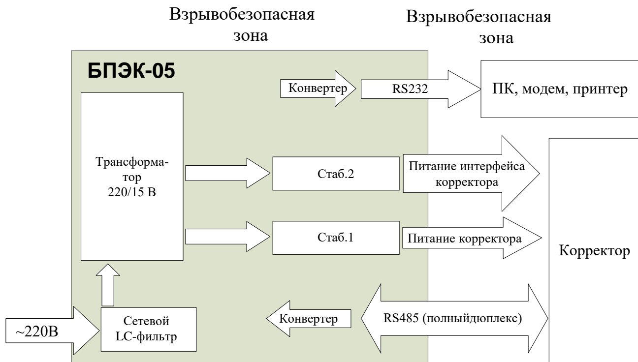
Рисунок 1 – функциональная схема блока питания БПЭК-05
