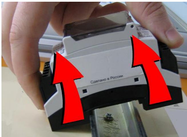
Рисунок 6 – Демонтаж модуля с DIN-рейки
