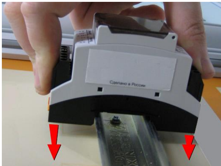
Рисунок 4 – Монтаж модуля на DIN-рейку
