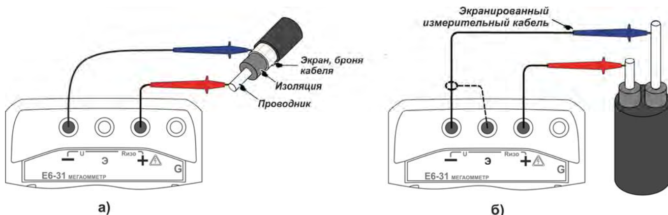
Рисунок 2.11 - Измерение сопротивления изоляции
