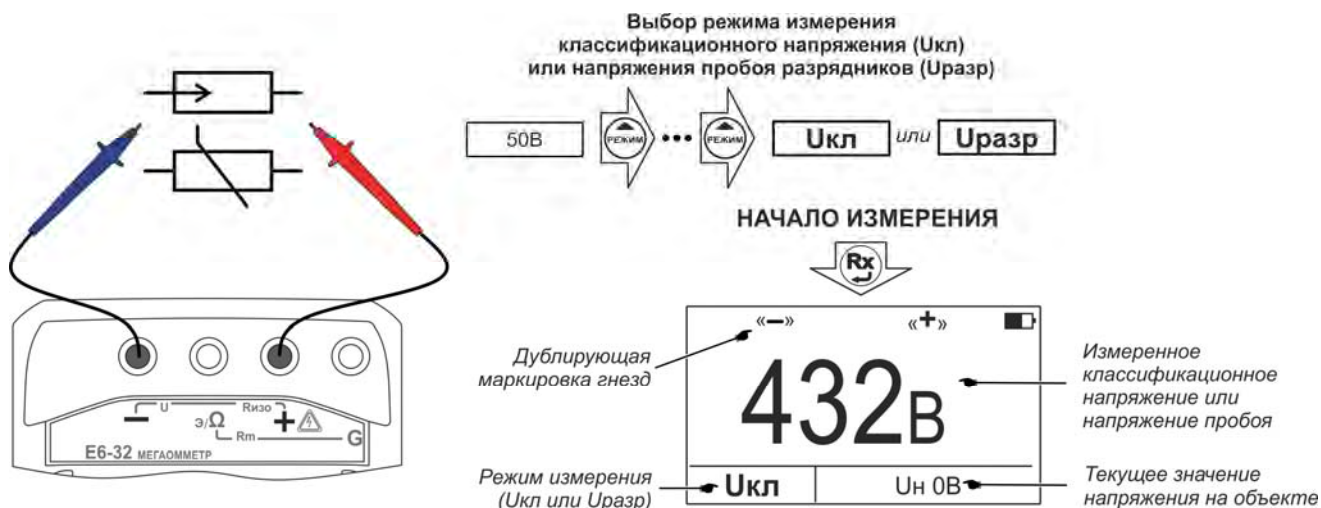
Рисунок 2.10 - Измерение классификационного напряжения или напряжения пробоя разрядников
